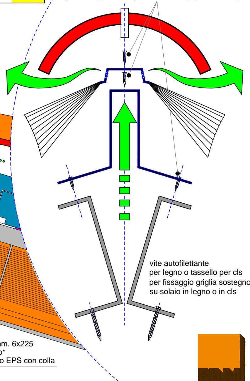
vite autofilettante per legno o tassello per cls per fissaggio griglia sostegno su solaio in legno o in cls
