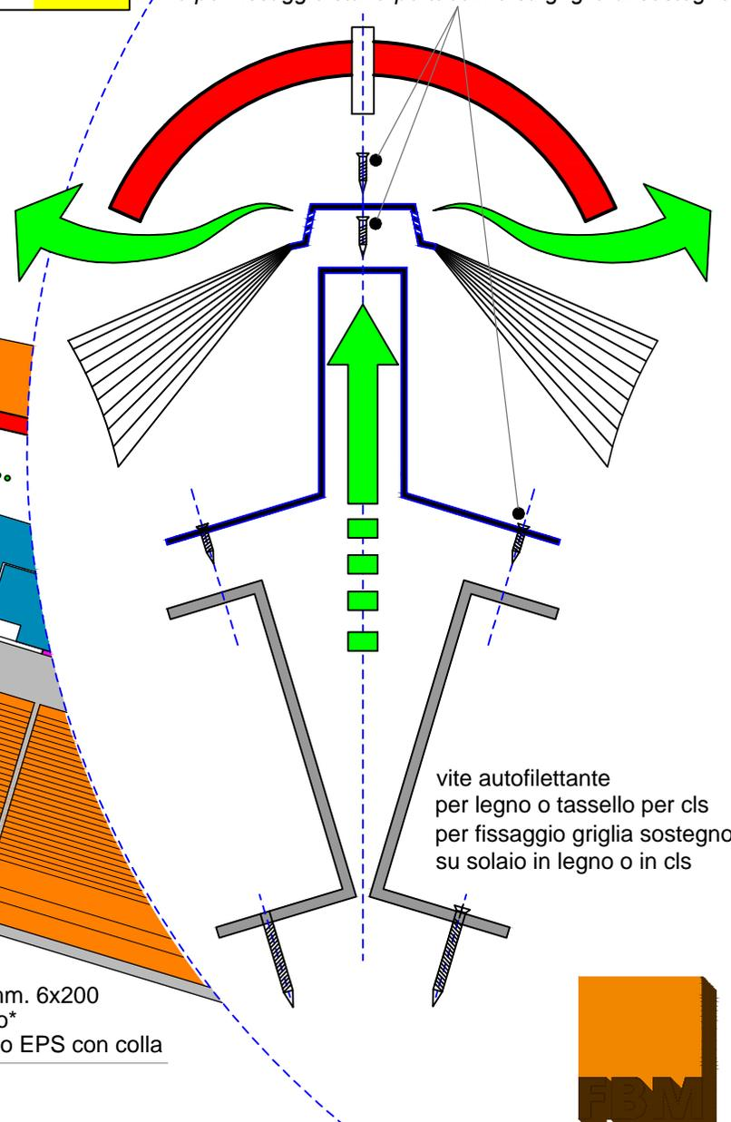
vite autofil. 5,5x16 testa 1/2 piana per fissaggio gancio fermacolmo su sottocolmo rigido per fissaggio sottocolmo rigido su staffa portacolmo e per fissaggio staffa portacolmo su griglia di sostegno
