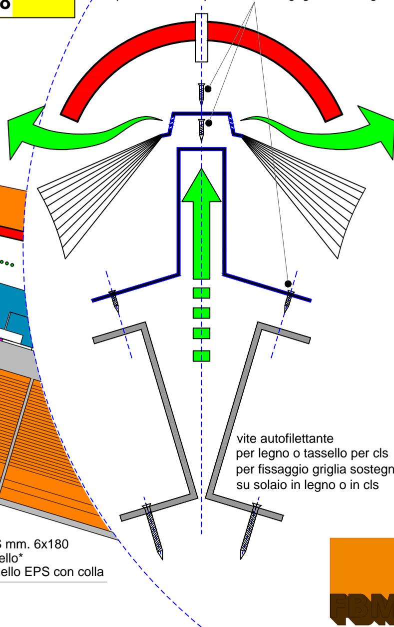
Chiodo in acciaio per CLS mm. 6x180 per fissaggio pannello/listello\*
