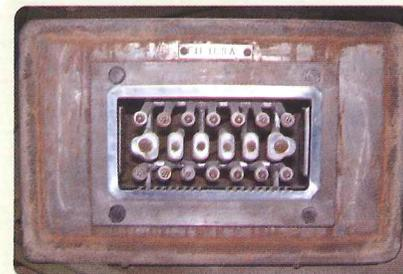
LA "BOCCA" DI UNA FILIERA RIPRODUCE, IN NEGATIVO, LA SEZIONE DEL MATTRONE CHE DA ESSA VIENE ESTRUSO
