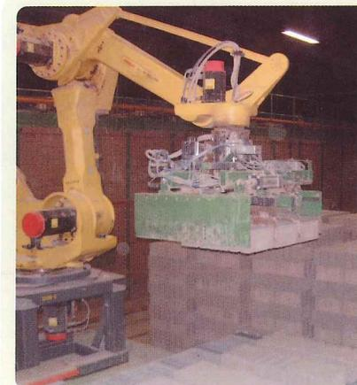
ALL'USCITA DALL'ESSICCATOIO, UN ROBOT POSIZIONA I MATTONI SUI CARRELLI CHE LI PORTERANNO NEL FORNO
